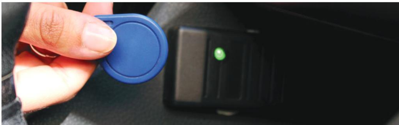
Obrázok č.6 Posádka sediaca vo výcvikovom vozidle sa identifikuje za pomoci RFID karty alebo čipu
